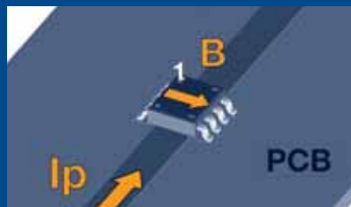
图2：一种可能的PCB设计：道槽放置在了Minisens的下面
